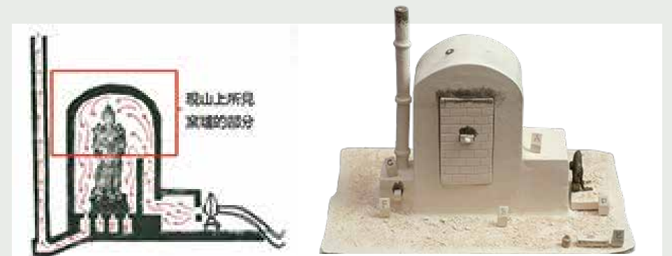
左：山上窯爐火焰流向示意圖(姚開麒先生繪製) 右：山上窯爐(Y1)陶瓷模型(司徒健先生作品、鍾木強攝)
