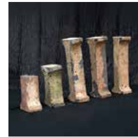
T型碳化硅耐火柱
